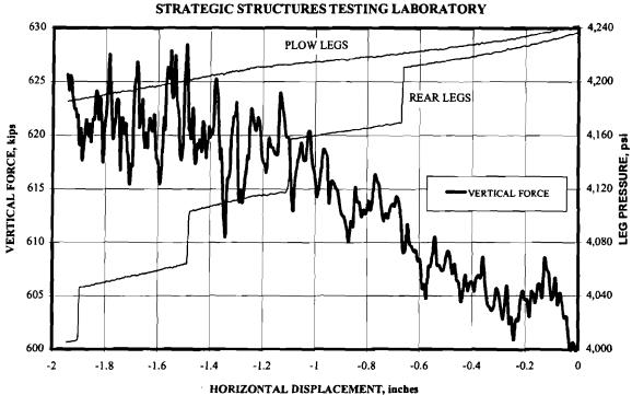
VAMT BREAKER LINE SUPPORT – 137 IN HEIGHT STRATEGIC STRUCTURES TESTING LABORATORY
