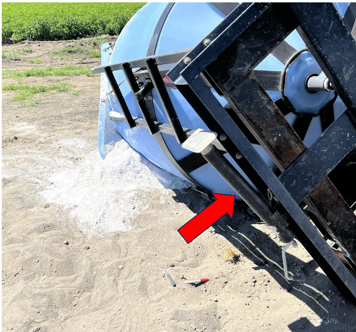
Imagen 3. Vista trasera del remolque y el tanque sobre terreno arenoso blando. La flecha apunta al gato no utilizado en la parte trasera del bastidor del remolque.
