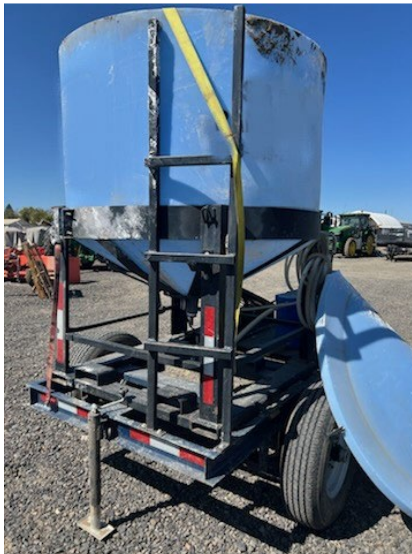
Imagen 6. Remolque en posición erguida después del incidente, con la escalerilla de mano y el gato trasero colocados sobre una superficie dura y nivelada.
