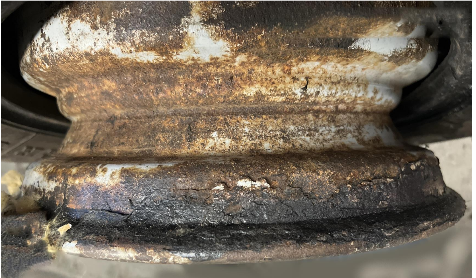
Imagen 4. Corrosión en el rin y el asiento del talón de la llanta.
