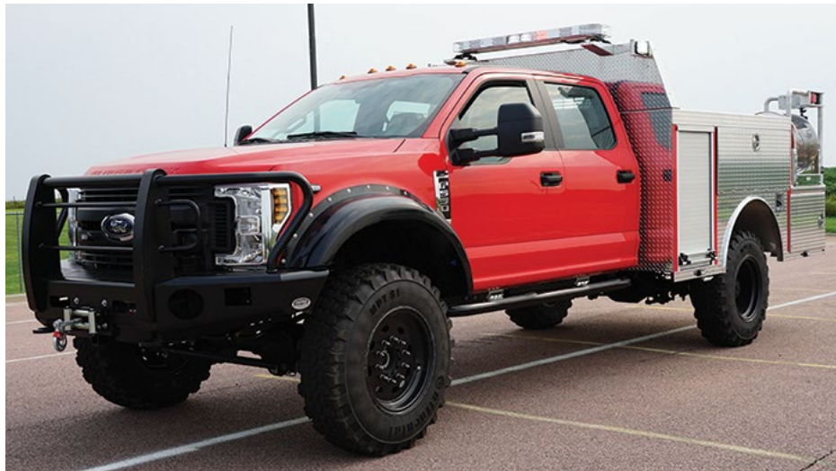
Imagen 1. Ejemplo de un Camión de Bomberos Forestales Tipo 6 (Personal de Aparatos de Bomberos y Equipos de Emergencia, 2019).
