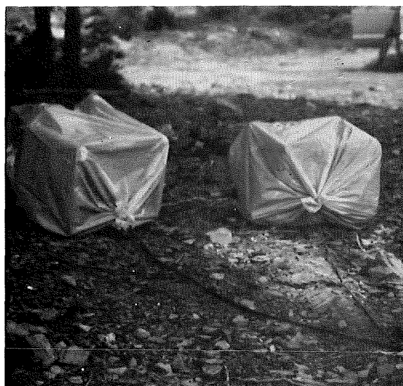
(D) Weather Proofing at Borehole Probe Location
