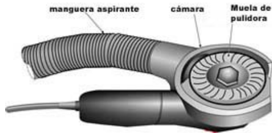
Figura 2 Diagrama de las partes principales de una pulidora.
