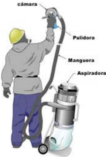
Figura 1 Pulidora en uso con sistema de control incorporado.
