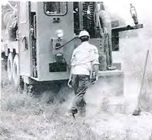
Figura 1: Taladrador de roca trabajando sin protección respiratoria en un equipo móvil.
