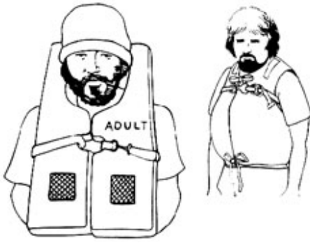
Figura 6 Chalecos salvavidas PFDs de Tipo 1 para ser usados mar adentro. (Fuente: ASGCP [1992]. Reimpreso con permiso. Dibujo realizado por V. Culp)
