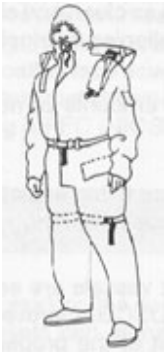
Figura 4 Overol PFD de Tipo V (Fuente: ASGCP [1992]. Reimpreso con permiso. Dibujo realizado por S. Laurie)
