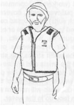
Figura 2 Chaleco PFD de Tipo III (Fuente: ASGCP [1992]. Reimpreso con permiso. Dibujo realizado por V. Culp)
