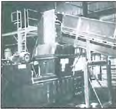
Figura 5. Enfardadora automática horizontal alimentada por medio de una banda transportadora.
