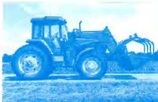
Foto 1. El tractor que aparece en la foto de arriba tiene una cargadora frontal equipada con un accesorio para fijar las balas (garabatos). La cargadora está en posición baja, que es la posición más segura posible cuando se están moviendo las balas.
