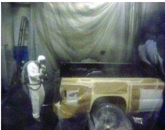
Operador con equipo de protección mientras aplica una capa de base.
