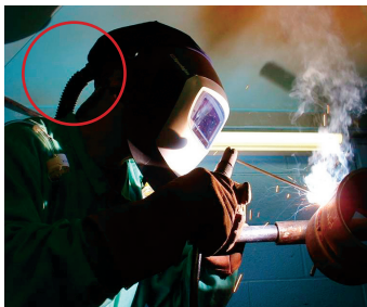
Un respirador protege a este soldador – la manguera del respirador está señalada con un círculo rojo.
