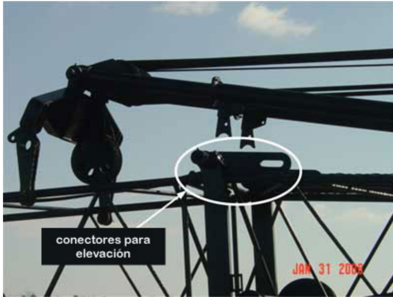
Foto 5. Esta fotografía muestra los conectores para elevación usados para asegurar el mástil y la pluma en plumas de 80 pies o menos (foto cortesía de NIOSHA)
