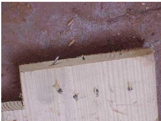
Foto 3. Esta foto ilustra el lugar de colocación del clavo 8d en el extremo de la vigueta que cedió (Foto cortesía de NCDOL/OSH).
