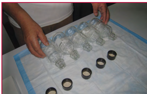
Figura 6: Quitando las tapas y rotando las botellas.
