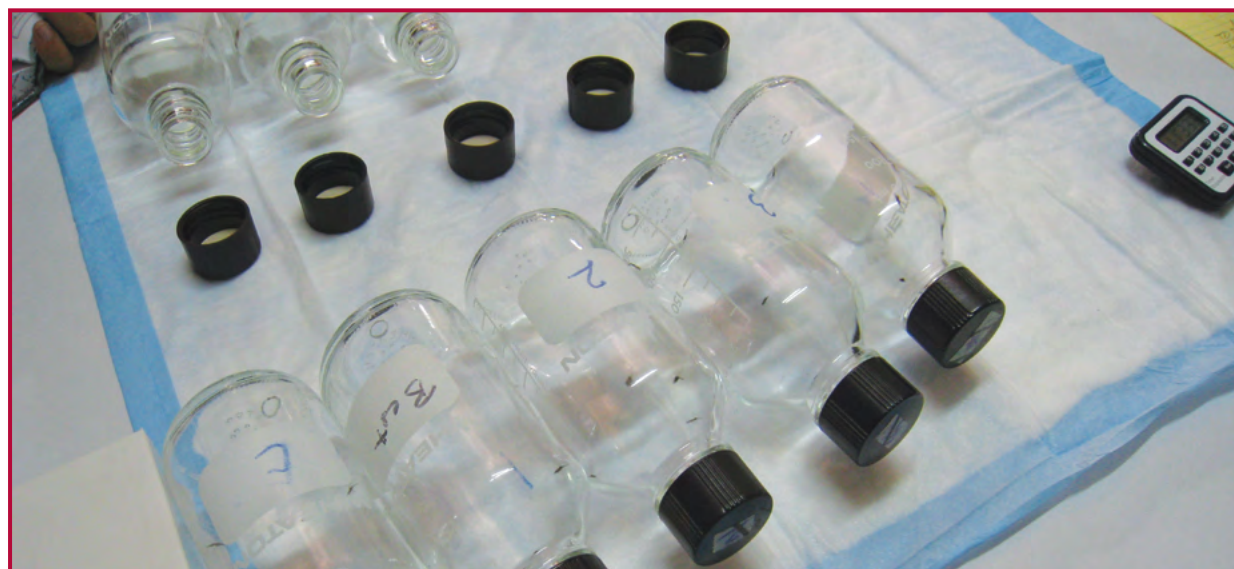
Figura 8: Ensayo biológico de la botella de los CDC en marcha.
