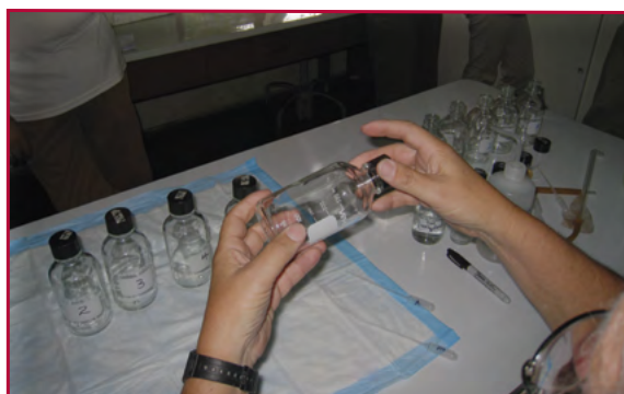
Figura 5: Recubriendo los lados de la botella.
