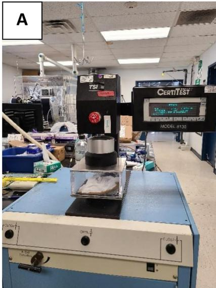
Fig. 2A. TSI 8130 Filter Tester
