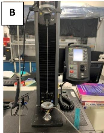
**Fig. 2B. Instron 5943 Tensile Tester**
