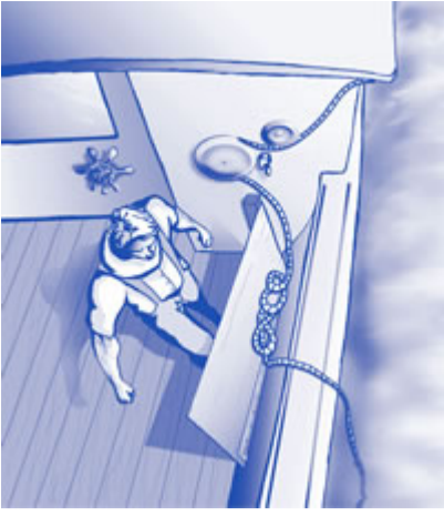
Figura 3. Repisa para la línea, hecha de madera contrachapada, con una bisagra que permite colocar la repisa en posición horizontal y depositar en ella la línea del halador de canastas. Ilustración de Media Stream.
