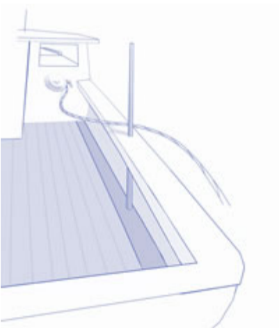
Figura 2. Un guiacabos instalado sobre la cubierta que “guía” la línea hacia afuera de la embarcación y minimiza el área donde la línea pudiera crear una situación de peligro. Ilustración de Media Stream.
